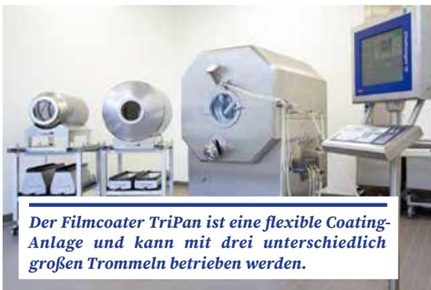
*Der Filmcoater TriPan ist eine flexible Coating-Anlage und kann mit drei unterschiedlich großen Trommeln betrieben werden.*
