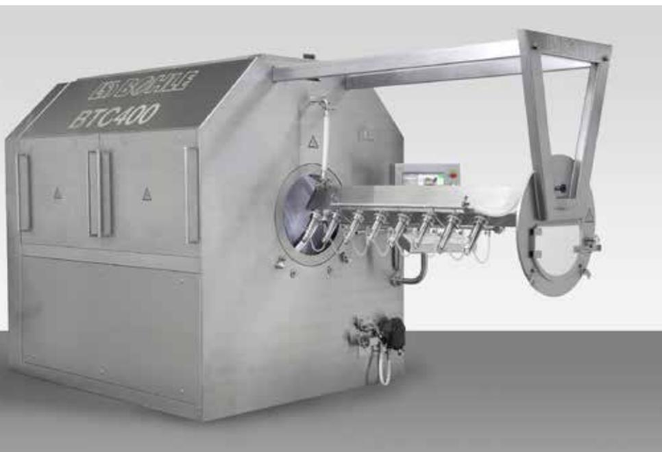
*Der Bohle Tablet Coater BTC steht für wirtschaftliches Tablettencoating. Ein flaches Tablettenbett, optimierte Luftführung und hohe Sprühmengen sichern die Qualität und verkürzen die Prozesszeiten um bis zu 35 %.*
